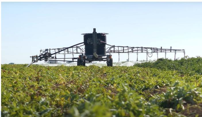
法国Oscar autonomous irrigation robot
