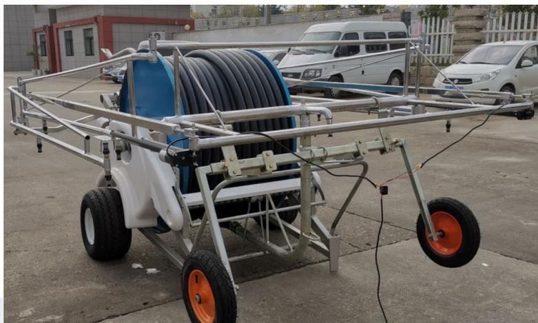
新型折叠桁架卷盘喷灌机
