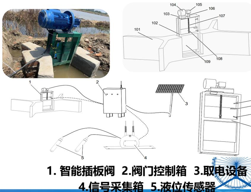
1. 智能插板阀 2. 阀门控制箱 3. 取电设备
