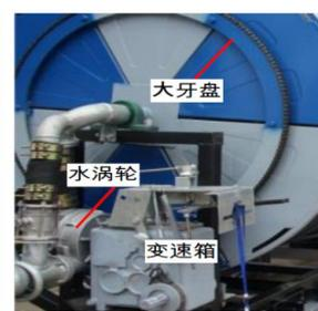
适配三种动力-减速箱直连结构
