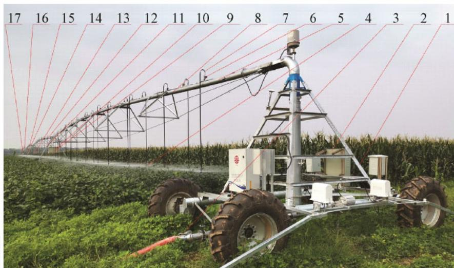
大型PWM变量喷灌机实体系统
